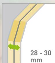
Eine ca. 1 mm Metalleinlage, die in den Schaumverbund eingelegt wird, sorgt für eine zusätzliche Verstärkung des gesamten Füllungsaufbaus.
