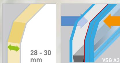
Bei dieser Ausführungsart besteht die innere wärmeisolierend beschichtete Scheibe aus zwei ca. 5 mm starken aneinandergeklebten Klarglasscheiben mit einem Prüfzeugnis für Durchwurfhemmung.
