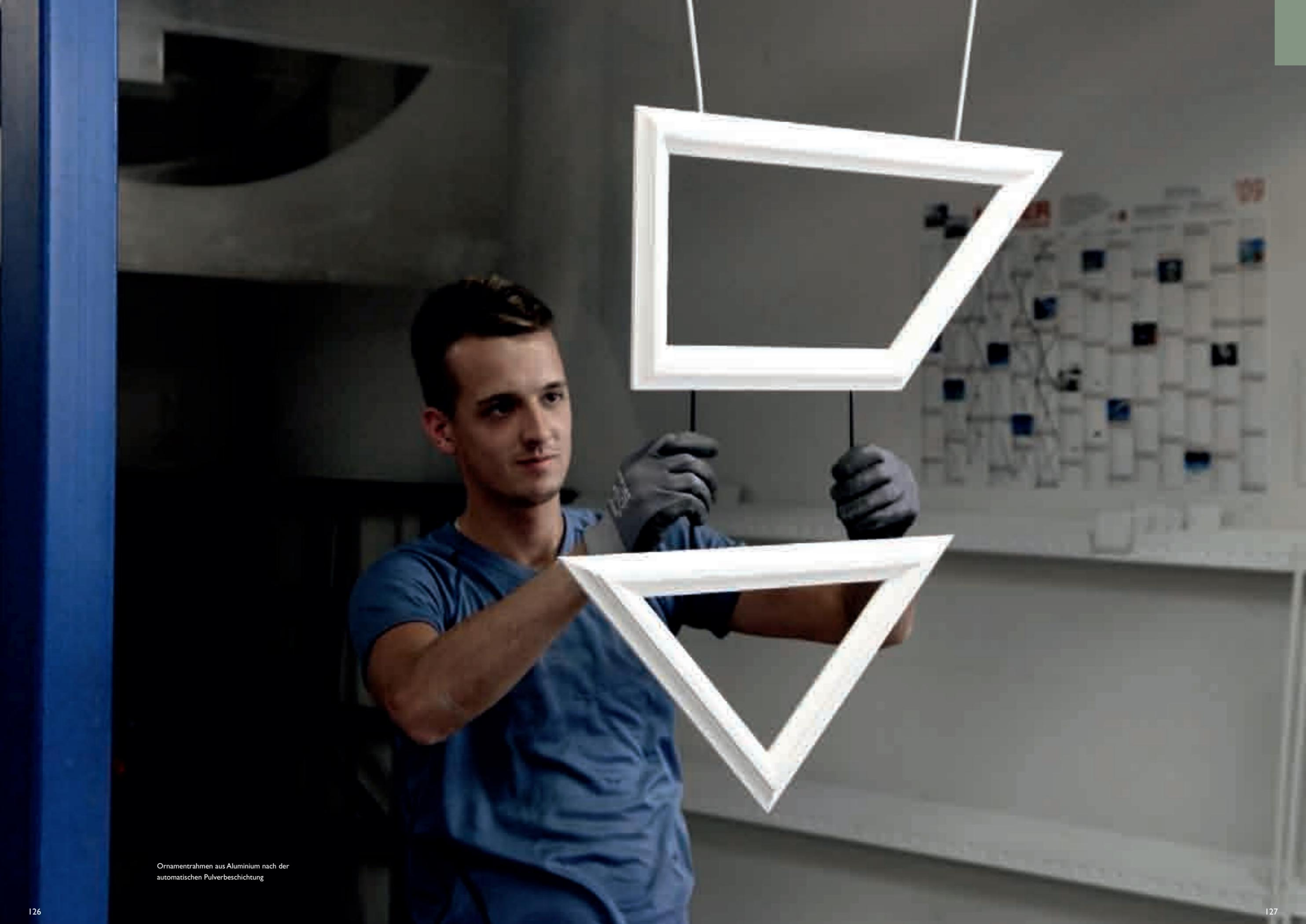
Ornamentrahmen aus Aluminium nach der automatischen Pulverbeschichtung
